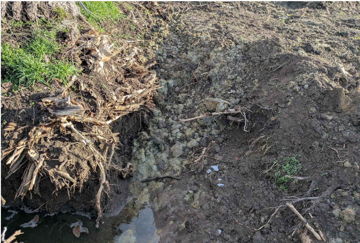
Abbildung 6: Foto vom Westrand der Fläche, dort wo zwei große Bäume standen. Der gebleichte Unterboden ist mit dem Oberboden vermischt, der hohe Grundwasserstand ist in der Grube gut zu erkennen.
